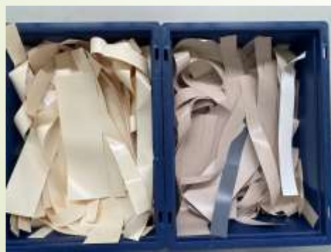
Bande de renfort intégrée dans les programmes de coupe et utilisée pour toutes nos toiles nécessitant un renfort
